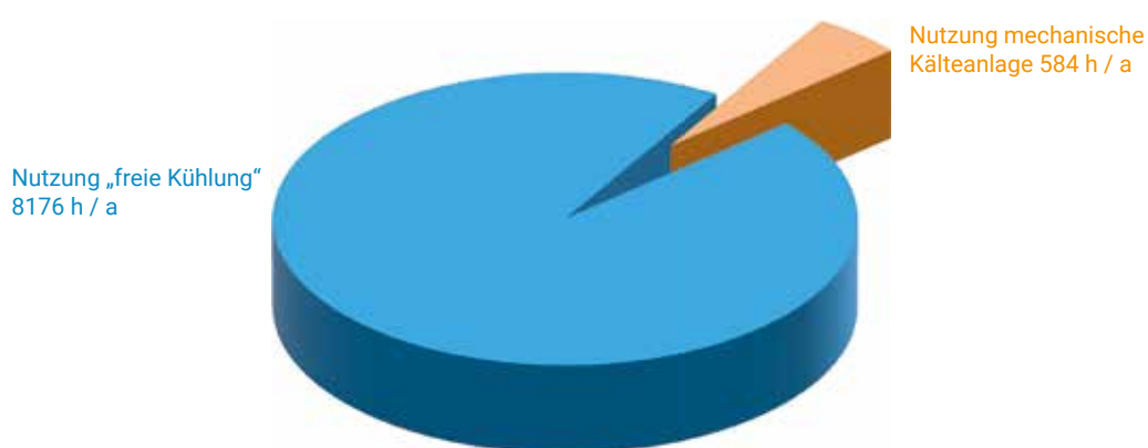
Abb. 1: Die Kälteanlage eines Slim Line Q15 Klimagerätes wird während knapp 7 % seiner Laufzeit genutzt.
